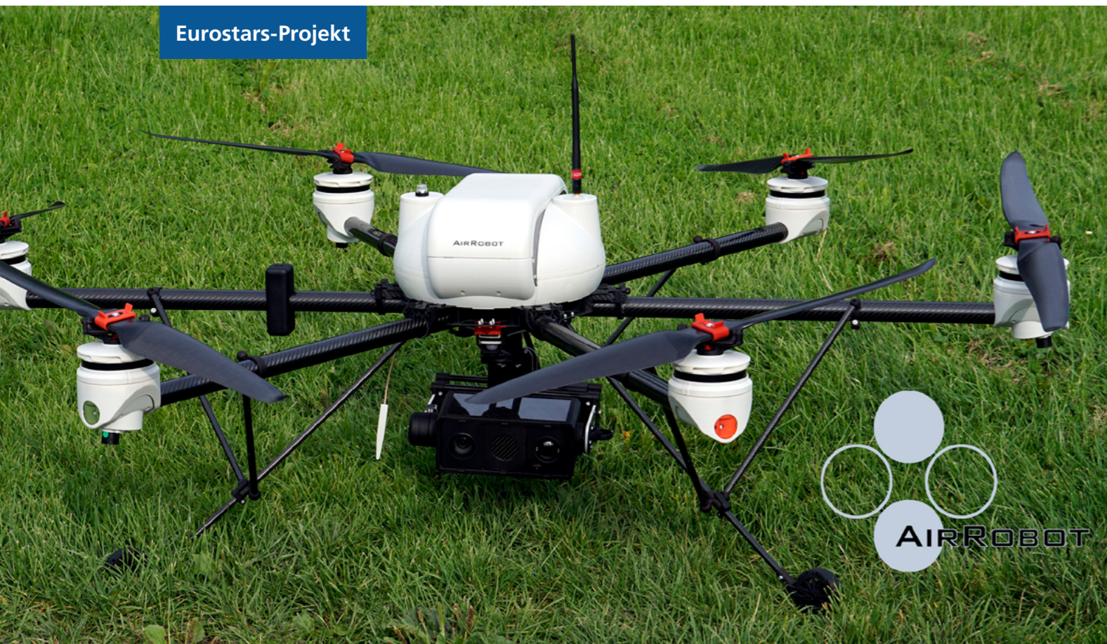
AirRobot Flugplattform AR200 mit Gimbal-Stabilisierungssystem für individuelle Nutzlasten und wackelfreie Aufnahmen. © AirRobot GmbH & Co. KG
